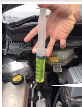
ダイレクトチャージクイックカプラで直接チャージも可能
